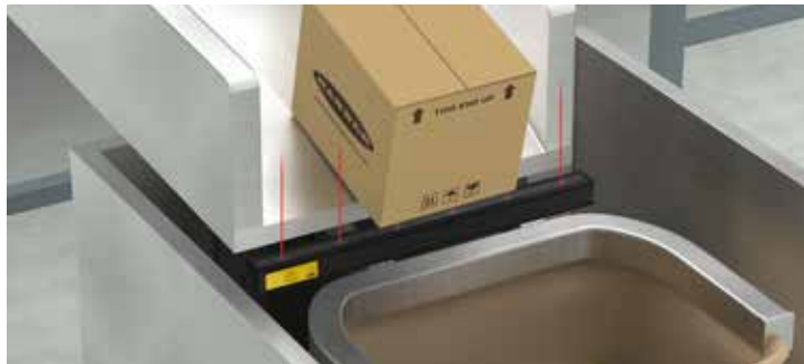
Robust Array Leading Edge Detection
